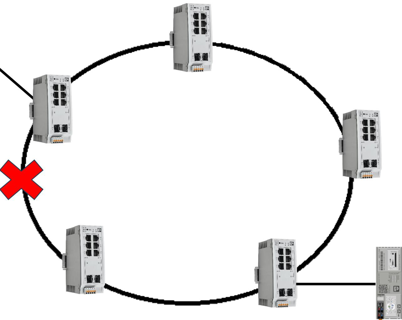
MRP (Media Redundancy Protocol) é um protocolo usado nas PROFINET para evitar falhas de comunicação em topologias em anel. Ele garante que, mesmo se um cabo ou dispositivo falhar, a rede continue operando quase sem interrupções. Isso aumenta a disponibilidade dos sistemas automatizados, reduz paradas e melhora a produtividade. O MRP é amplamente utilizado em setores energia, mineração, sulcoalcoleiro, papel e celulose, e diversos outros.
